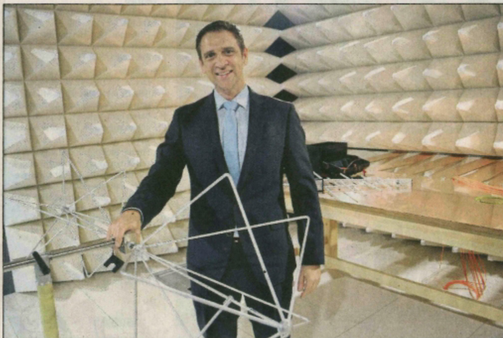
Stille herrscht in der Absorberkabine des KFE. Wie Tobias Möller erläutert, werden hier unter anderem Komponenten darauf getestet, wie viele elektromagnetische Störungen sie verursachen. Foto: Osmic
