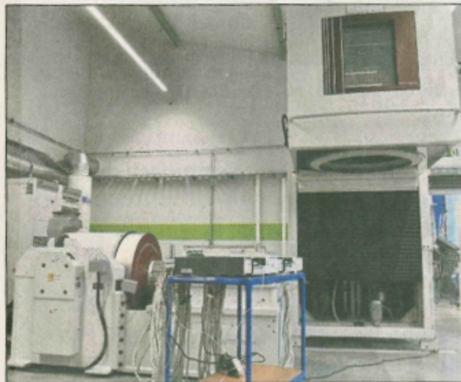
Im neuen Schwingungslabor des KFE erzeugt ein elektrodynamischer 40-Kilowatt-Shaker Vibrationen, um eine beschleunigte „Alterung“ des Prüfobjekts herbeizuführen. Foto: Sanimir Osmic
