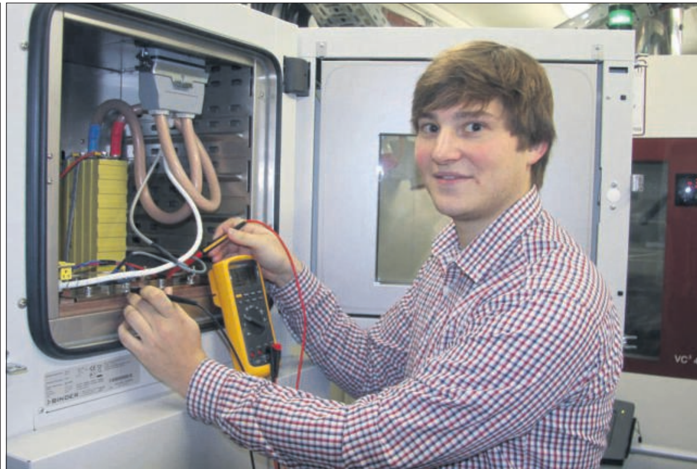
Stefan Menke ist mit der Eröffnung des Batterielabors namens KFe-Lab zum Team in Lippstadt gestoßen. Hier zeigt der 24-Jährige die Untersuchung einer Batteriezelle im Temperaturschrank. ■ Fotos: Schwade
