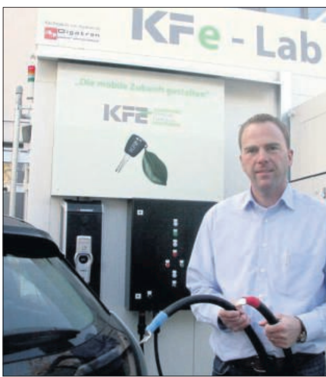
Carsten Wiesemann-Hesse vor dem Außenanschluss des Batterielabors: Hier können Batterien auch getestet werden, wenn sie in einem Elektroauto unter Leistung stehen.
